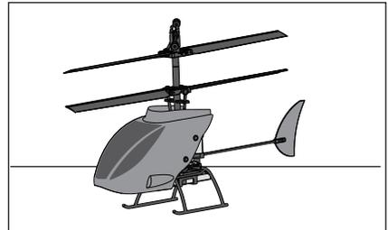
Stellen Sie den Hubschrauber auf eine flache gerade Oberfläche. Das Kreiselsystem des Hubschraubers wird dann initialisiert. Bitte bewegen Sie den Hubschrauber nicht bis die rote LED auf der Hauptplatine leuchtet.
